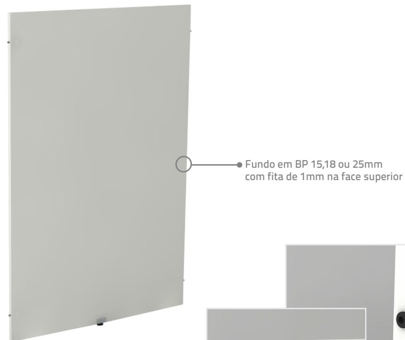
Para a espessura de 15mm a fixação do fundo é realizada através de conjunto minifix. Para as espessuras de 18 e 25mm a fixação é realizada através de parafusos estruturais.
